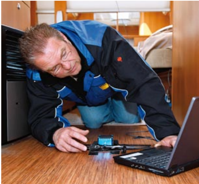
Präzise: Die Messtechnik erfasst gefahrene Geschwindigkeiten, die Stärke der Pendelbewegungen und schließlich ihr Ausklingen
