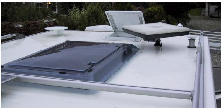
Satellitenempfang ist für den Empfang der örtlichen, terrestrischen Sender eine MAXVIEW GAZELLE 360° TV/UKW-Antenne installiert. Diese Antenne hat den Vorteil, dass man sofort ohne sichtbar ausgefahrene Teile empfangsbereit ist.
