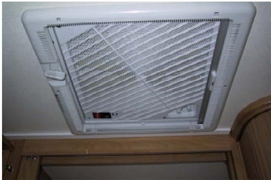
Der Einbauort mit dem Ausschnitt von 40 X 40 cm ist so gewählt, dass an gleicher Stelle auch eine Electrolux Klimaanlage 1100/1500/1900 eingebaut werden kann.
