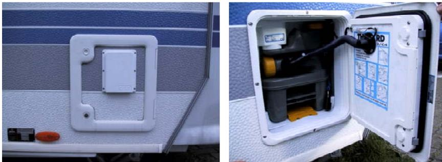
Die Entlüftung wird nach Herstellervorschrift eingebaut. Der elektrische Anschluss erfolgt am TB2. Das Stromersorgungskabel kann gut hinter der Abdeckblende verlegt werden. Als Kabelzughilfe zum Waschtisch und TB2 dient eine steifer Draht.
