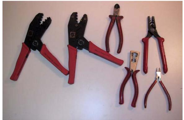
Abbildung 53: Crimpzangen, Seitenschneider
