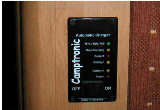
Die Fernbedienung gestattet die bequeme und vollständige Fernkontrolle des Ladegeräts wenn dieses, wie in diesem Fall, an einer schwer zugänglichen Stelle in Akkunähe montiert ist.
