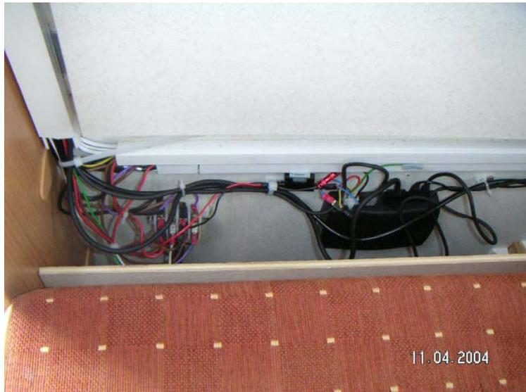
Die Kabel und die Radioantenne sind in angeschraubten Kabelkanälen verlegt.
