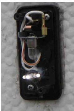
In die Umrissleuchten sind zusätzliche Lampen aus jeweils 3 in Reihe geschalteten und mit Vorwiderstand versehene superhellen LED's montiert die getrennt für rechts und links als Parklicht (entspricht nicht der STVZO) schaltbar sind. Die Parklichter wurden in einem 8mm Aluminiumrohr Wasserdicht eingedichtet. Eine LED-Gruppe zieht einen Strom von 0,02 Ampere (= 0,24 Watt).
