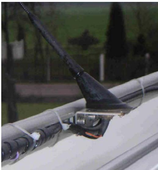
Die Antennen sind auf rostfreie Hilfswinkel, die mit Gleitmuttern an die hintere Reling befestigt sind, montiert. Für eine einwandfreie Masseverbindung muss die hintere Traverse der Reling mit einem kurzes Kabel mit 2 Ösen, mit einer der beiden Seitenrelingen verbunden werden.
