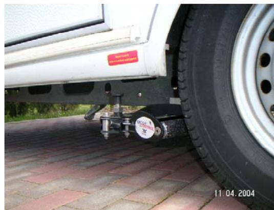
**Abbildung 46: Reibradantrieb**
